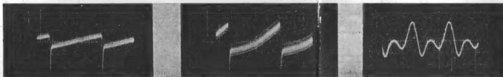
9. Terminale D. 8 V - p.p. Deformazione verticale negativa. 10. Terminale F. 10V - p.p. Onda di tensione verticale verde. 11. Terminale A, B, C. 15 V - p.p. Tensione ai capi della bobina "orizzontale blu" I<sub>803</sub>.
