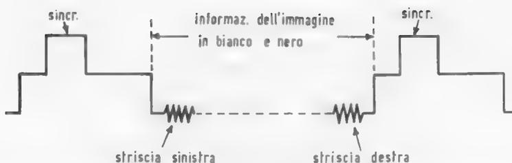
FIG. 228. Posizione dei segnali delle strisce colorate nel videosegnale composto.
