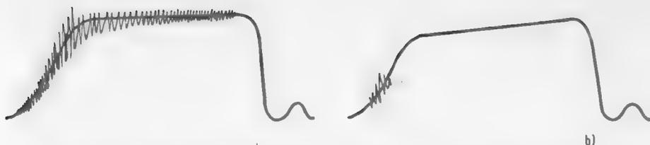
FIG. 170. a) Aspetto del segnale di marcatura sopra un oscilloscopio a larga banda;
